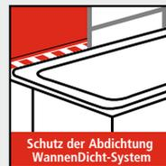
Schutzzone im Sanierungsfall beim Entfernen der Silikonfuge am Wannenrand
