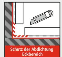
Schutzzone (mittig geknickter Schnittschutz) bei exakter Ecklage der Bewegungsfuge
