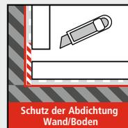
Schutzzone im Sanierungsfall bei korrekter Lage der Fliesen zum Schnittschutz
