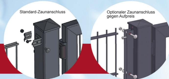
Zaunanschluss für Stabmatten mit Edelstahlwinkeln (inkl.) oder optional gegen Aufpreis mit Zaunanschlussleiste.
