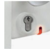
Elektrisches Schloss als Alternative zum E-Öffner. Eine Verriegelung erfolgt durch angelegten Strom. Bei Stromausfall öffnet sich das Schloss automatisch (Feuerschutz). Knauf-Drückerpaar standardmäßig dabei. Transformator und E-Material sind nicht im Lieferumfang enthalten.
