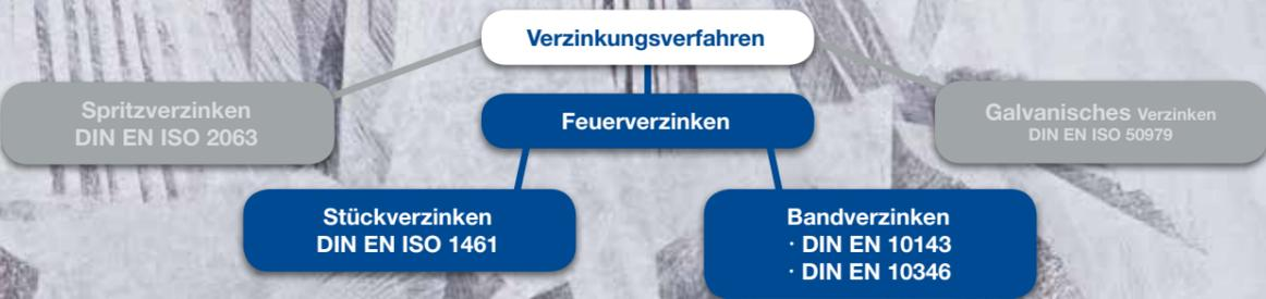
Im Bereich des Stahl- und Metallbaus wird der Korrosionsschutz durch Feuerverzinken seit Jahrzehnten erfolgreich eingesetzt. Dies gilt sowohl für kleine Bauteile wie Balkongeländer; aber auch für große Bauteile wie Stahlträger. Durch die Verzinkung und den damit einhergehenden Korrosionsschutz wird die Lebensdauer erheblich verlängert, sodass in der Regel keine Folge- und Instandhaltungskosten entstehen, da die Schutzdauer üblicherweise die Nutzungsdauer übersteigt.
